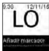
El nivel de glucemia puede estar por debajo del intervalo de medición del sistema.
