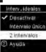
Pulse **▼** o **▲** para resaltar **Desactivar**, **Intervalo único** o **2 intervalos**. Pulse **OK** para seleccionar una opción (**2 intervalos** en el ejemplo).
