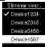
Pulse **▼** o **▲** para resaltar el dispositivo a eliminar. Pulse **OK** para guardar la opción.
