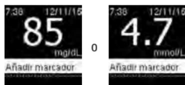
Después de realizar una medición de glucemia el resultado de medición se visualiza en la pantalla con la opción **Añadir marcador** resaltada. Pulse **OK** para añadir un marcador.
