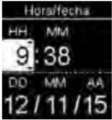
Pulse **▼** o **▲** para ajustar cada campo. Pulse **OK** para guardar y pasar al campo siguiente. Ajuste **am** o **pm** si es necesario.
